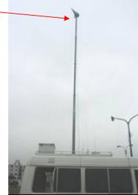
Antena Omnidireccional para prueba de movilidad
